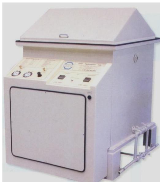
**Figura 02:** Imagem da Câmara de Névoa Salina - BASS.
